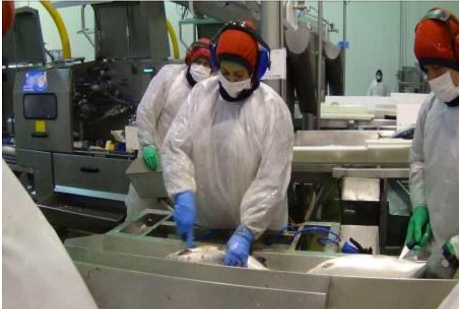
Figura 7. Corte de Branquia y Eviscerado
