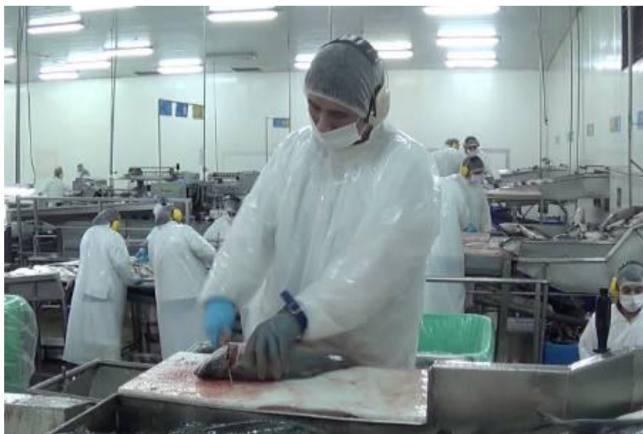
Figura 10. Corte de Cabeza Hg
