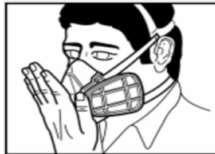
Prueba de Presión Positiva Máscara de Rostro Completo (Filtros con ajuste tipo bayoneta)
