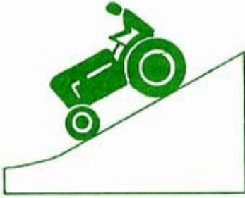
Esto aumenta el peso en las ruedas delanteras y hay mayor posibilidad de volcarse. Evite las cargas pesadas y mantenga el tractor enganchado.
