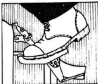
4.- Para iniciar la marcha se debe soltar el pedal de embrague suavemente, especialmente cuando se suba una colina o se trate de salir de una zanja.
