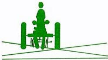
No las intente con excesiva rapidez ni a sacudidas. Al dar vueltas no frene con un solo freno. Al cambiar las zonas de trabajo frene con ambos frenos a la vez para una operación simultánea.
