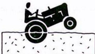
Al poner el tractor en movimiento algo se moverá. Si las ruedas están enterradas, girará sobre su eje. Si no puede retroceder, pida ayuda.
