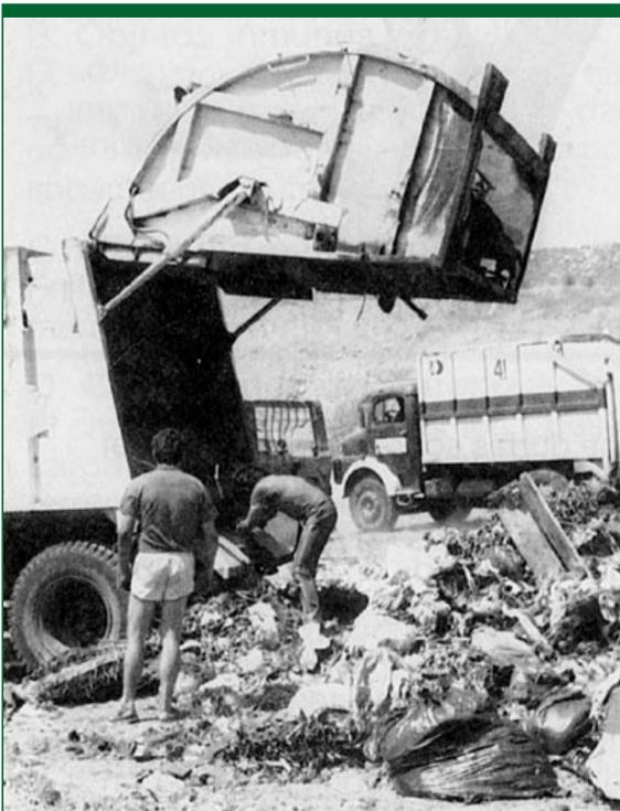
*Trabajador en posición peligrosa cuando se descargan los desechos, debajo de la compuerta trasera.*
