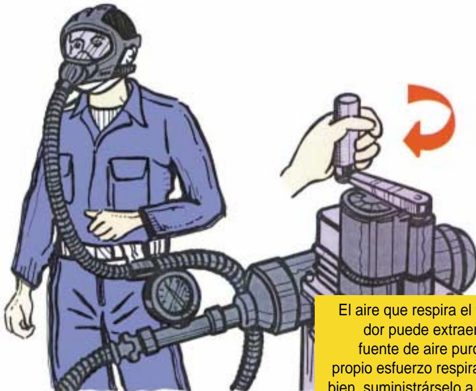
El aire que respira el trabajador puede extraerlo de la fuente de aire puro por su propio esfuerzo respiratorio, o bien, suministrárselo a presión mediante un equipo accionado mecánicamente o a mano. También puede recibir el aire a través de un tubo desde una fuente de aire comprimido.
