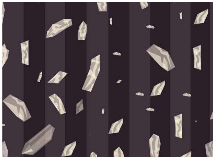
Cristales de cuarzo retenidos en un filtro donde se tomó una muestra de aire.
